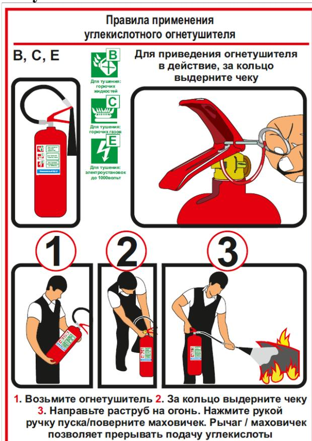
7.4.3. Углекислотные огнетушители (исходя из содержания паров воды в заряде) выпускаются для работы в диапазоне температур от -20 до +50°C и тушения электроустановок, которые находятся под напряжением до 10000 В или в целях работы в диапазоне температур от -40 до +50°C и тушения электроустановок, которые находятся под напряжением до 1000 В.
