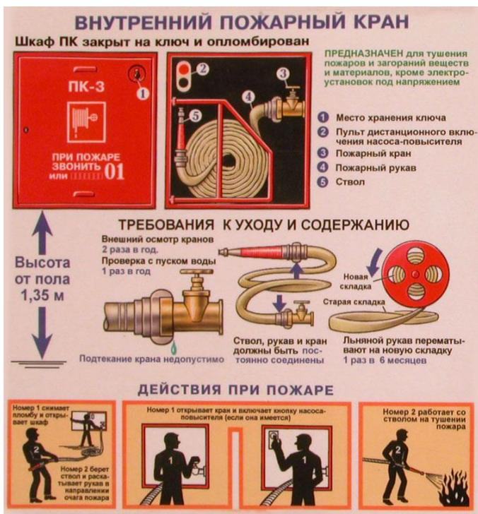
Рисунок 5 Схема внутреннего пожарного крана
